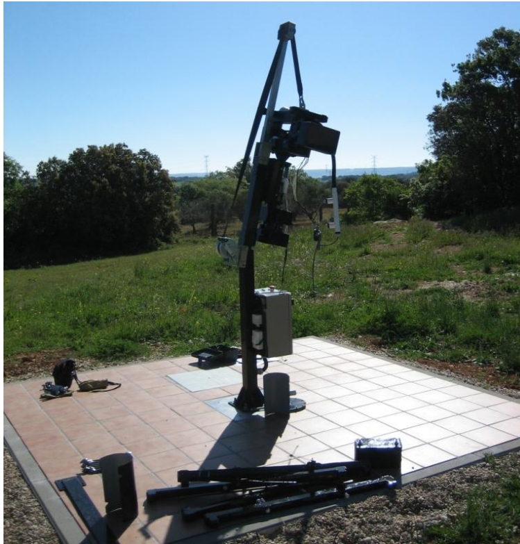
Figura 15: Elevación del motor de azimut.
