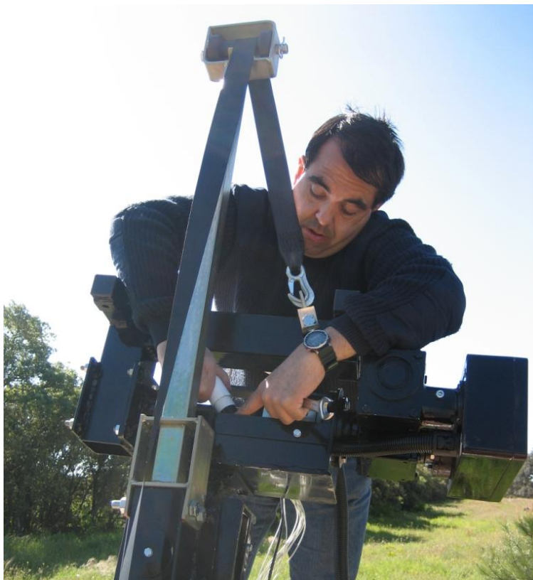
Figura 16: Instalación del motor de elevación.
