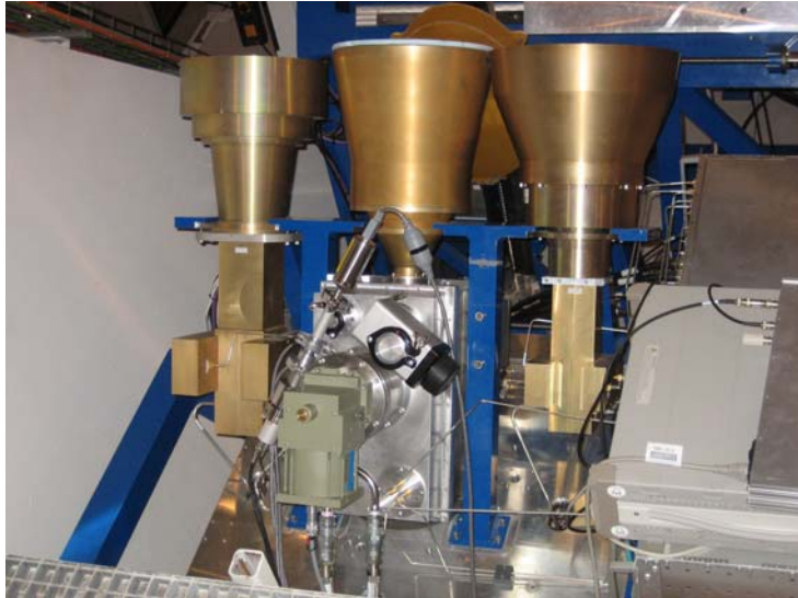
figura 1: Receptor banda C instalado en la cabina de receptores
