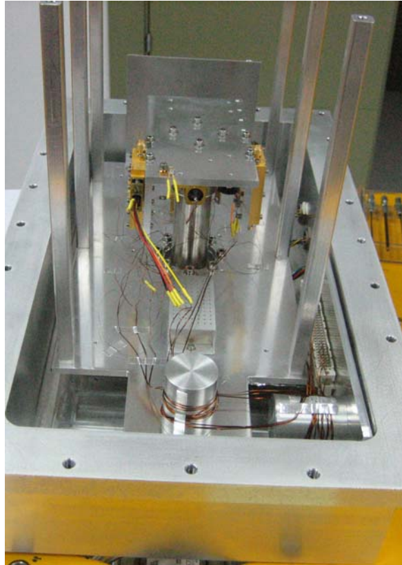
figura 25: Amplificadores banda C instalados en el criostato
