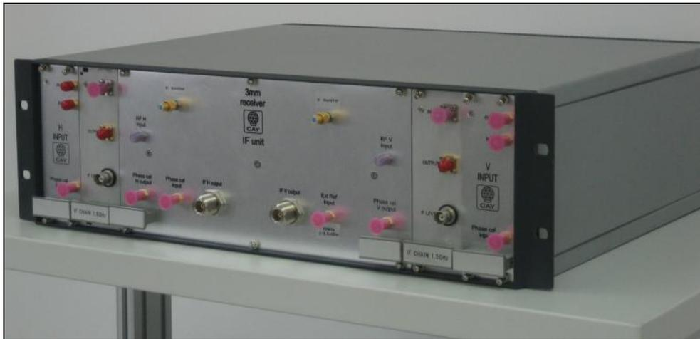
**Figura 1.-** Unidad de FI del receptor de 3mm.
