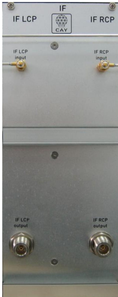
Figura 34: frontal montado del módulo de IF
