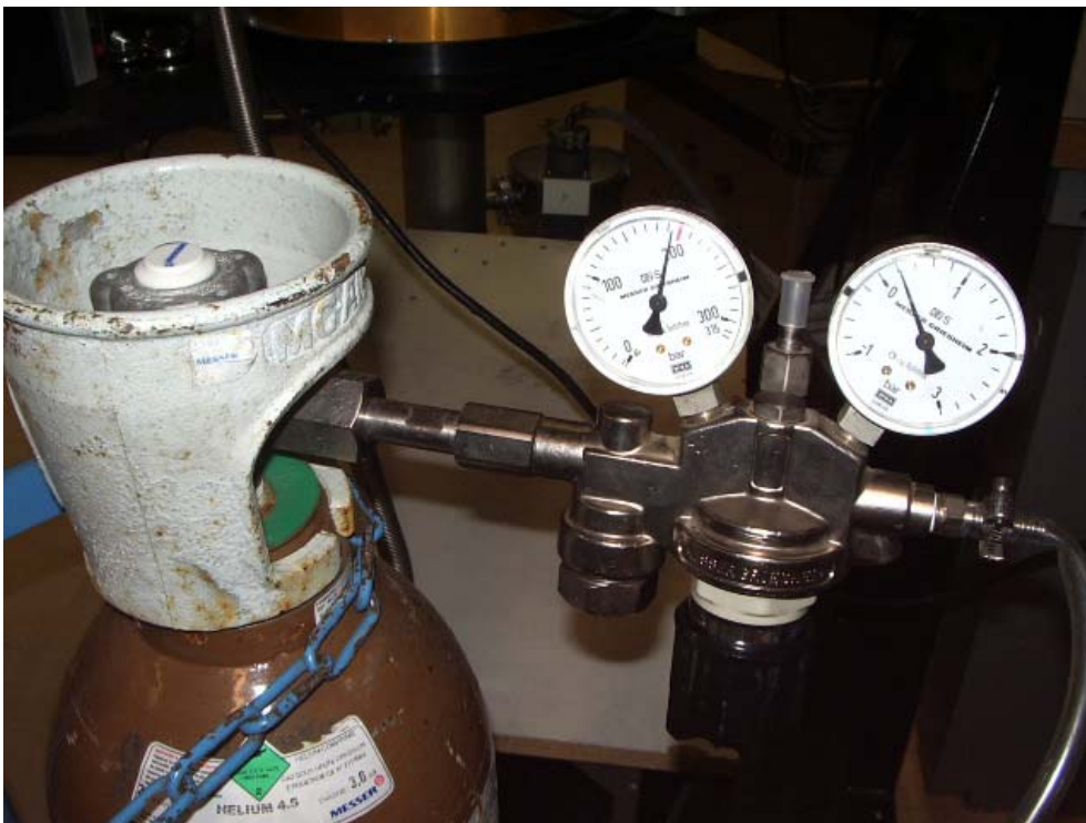
figura 6: Bombona de helio gas y manómetro
