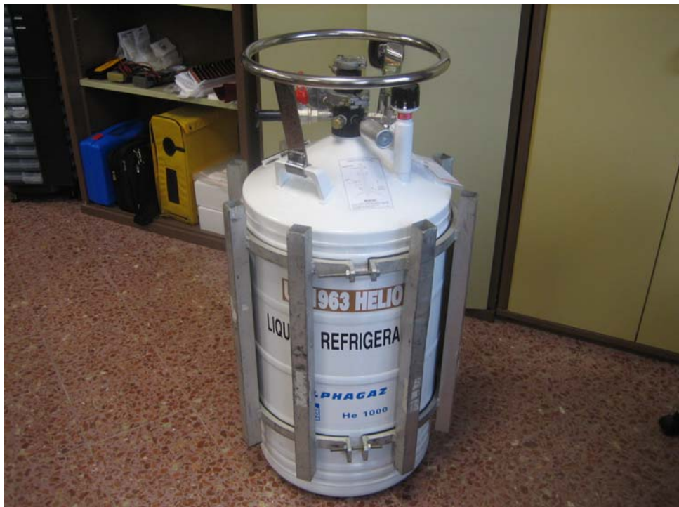
figura 2: Depósito de 65 litros de He líquido
