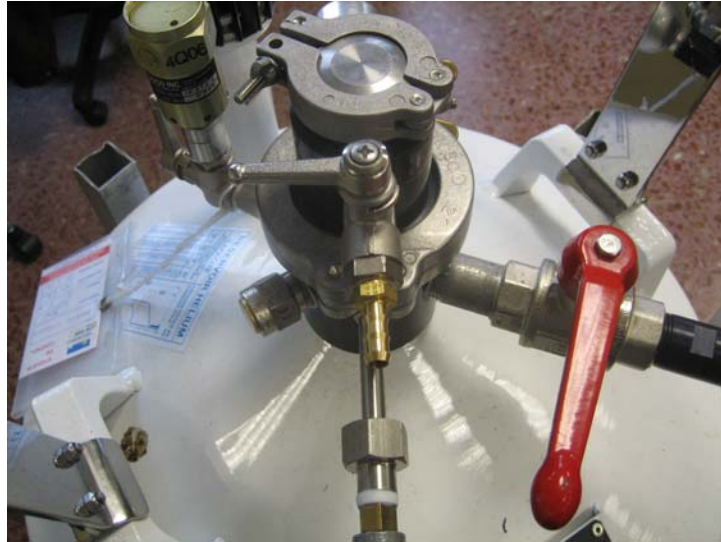
figura 8: Entrada de He gas del depósito de He líquido
