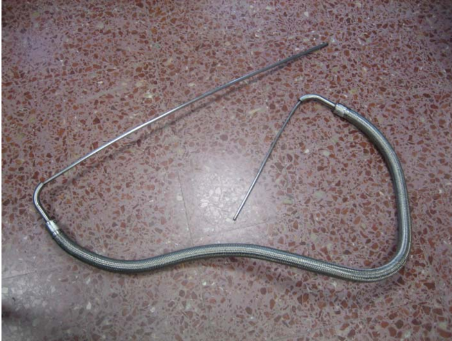
figura 3: Línea de transferencia de helio
