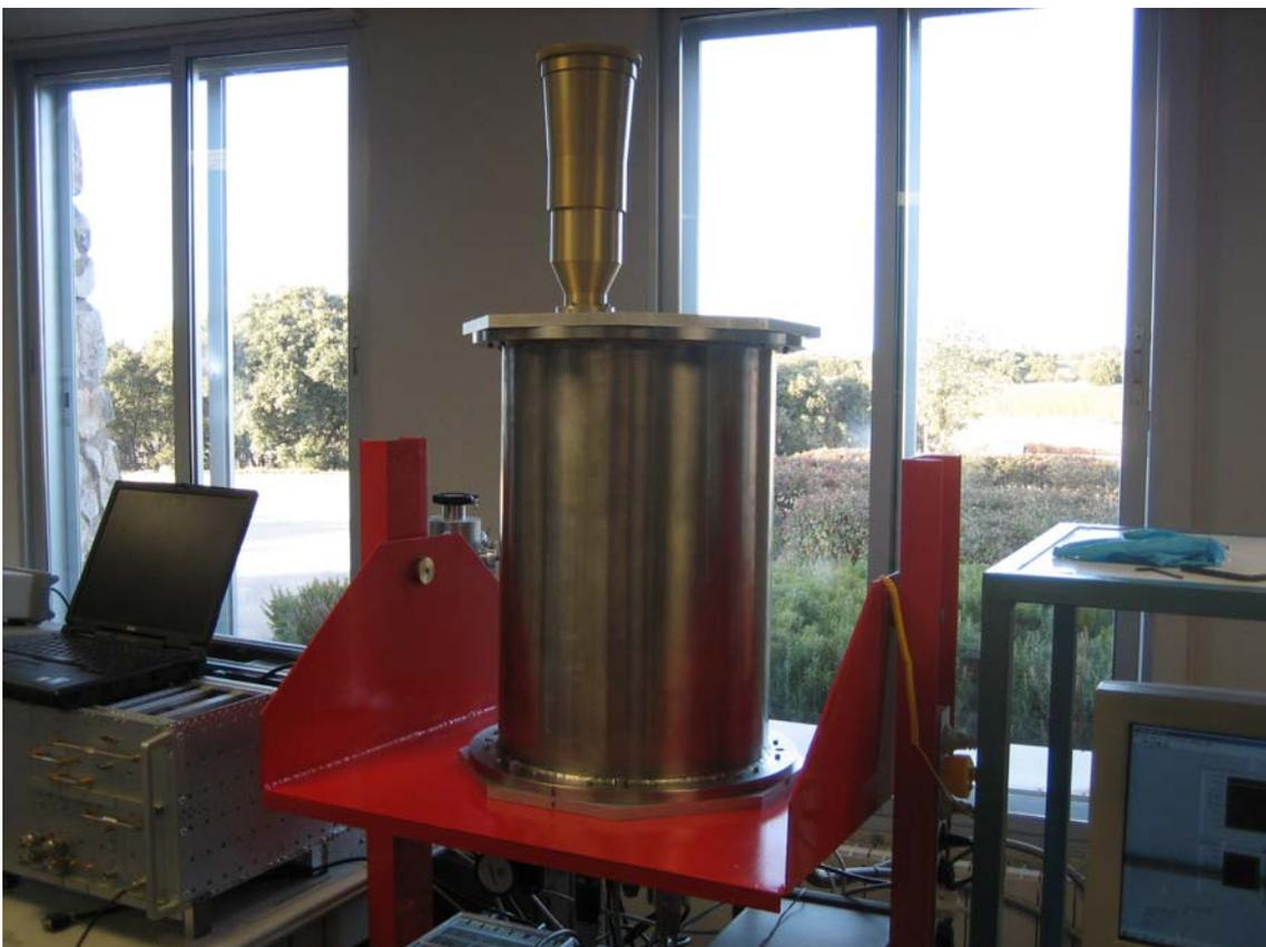
figura 62: Receptor banda X en el laboratorio
