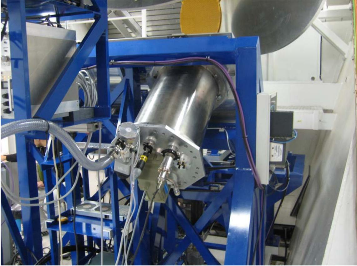
figura 63: Receptor instalado en la rama M4' de la antena ARIES XXI
