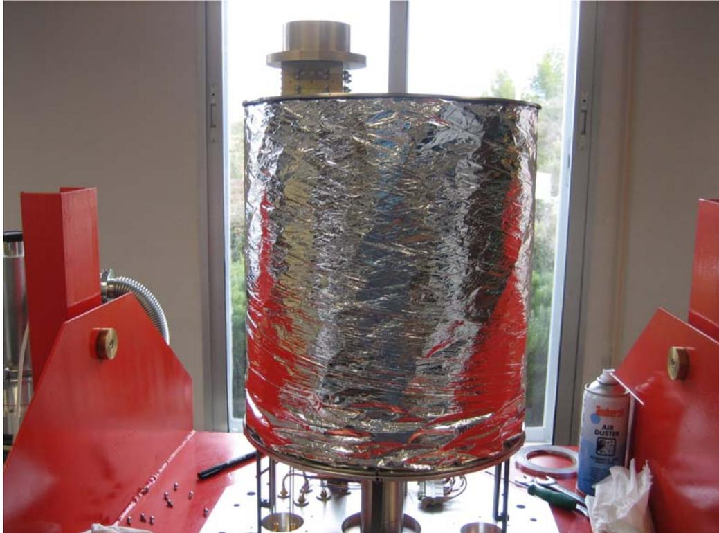
figura 41: MLI instalado en el cilindro exterior de la etapa intermedia
