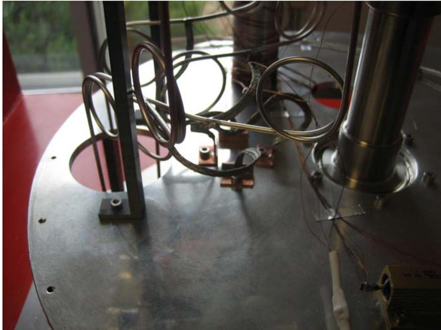
figura 50: conexión de los cables semi-rígidos a la etapa intermedia
