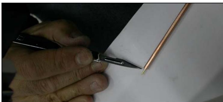
6. Eliminar, en caso necesario, el teflón que por calor se haya salido del conductor exterior, con ayuda del microscopio y del bisturí.
