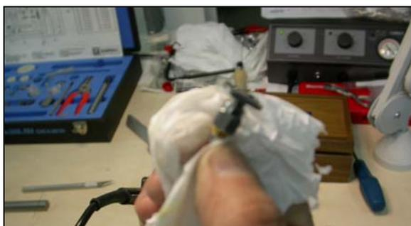
8. Comprobar que la distancia del pin central al plano de referencia del conector está en el rango: 1,32-1,47mm. Utilizar los gauges de Maury.
