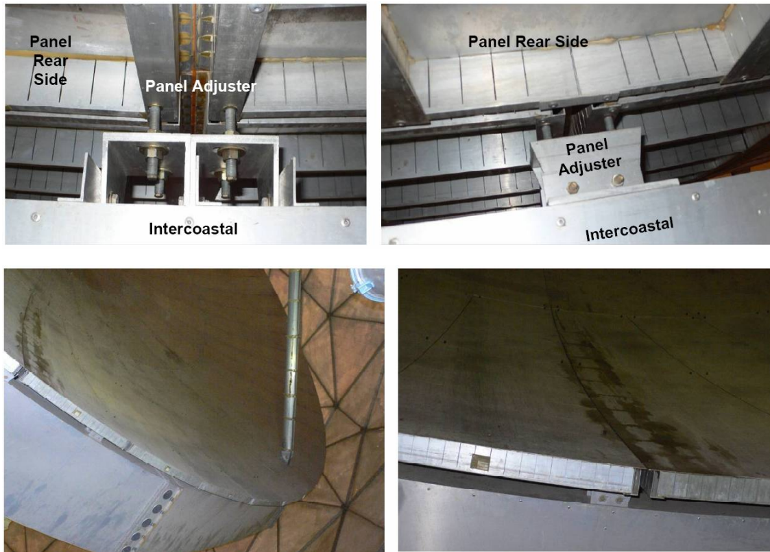
Figura 12: Los ajustadores y los paneles de aluminio
