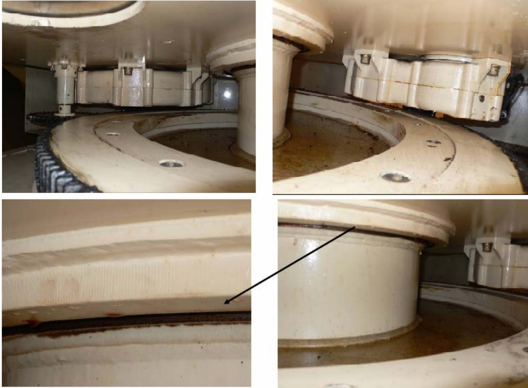
Figura 24: Engranajes de azimut (figura superior). Cojinetes de azimuth (figura inferior)
