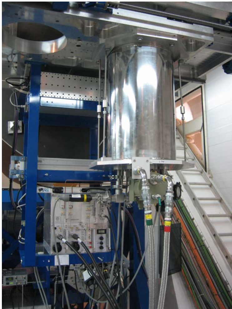
Figura 1: Receptor de 22 GHz dispuesto en su posición definitiva en la rama de baja frecuencia de la sala de receptores del radiotelescopio de 40 metros.
