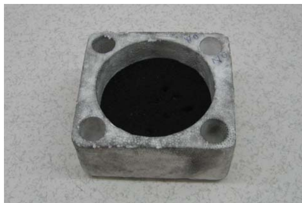
Figura 3: Carga fría utilizada para la medida de ruido.
