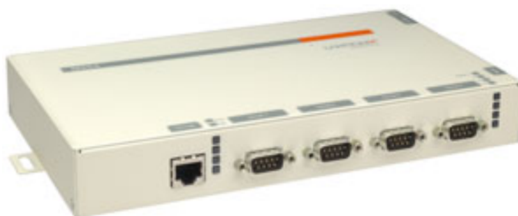
Figura 1: Frontal de un conversor Ethernet - Serie de la marca Lantronix, modelo MSS4. Se observan los cuatro puertos serie DB9 y el puerto Ethernet. Los 8 LEDs en el panel frontal indican el estado de funcionamiento del dispositivo. Los 4 LEDs de la derecha indican el estado de funcionamiento de los puertos serie. Los LEDs de la izquierda indican si hay actividad por el puerto Ethernet y el estado del MSS4.
