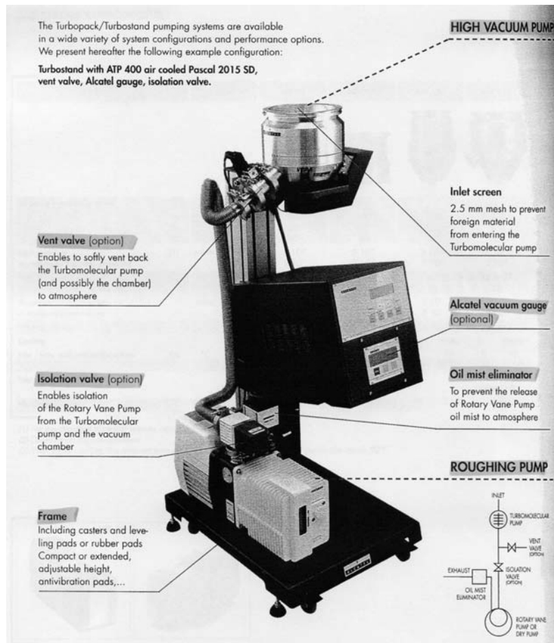
figura 37: Sistema de vacío de Alcatel empleado. Bomba rotatoria y turbomolecular
