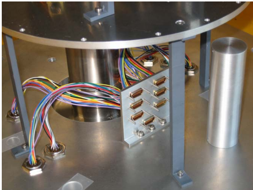
figura 10: Interconexión entre los conectores fischer y los MDM15
