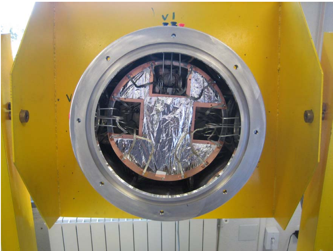
figura 83: Malla estañada que interconecta los cables de RF con la etapa intermedia
