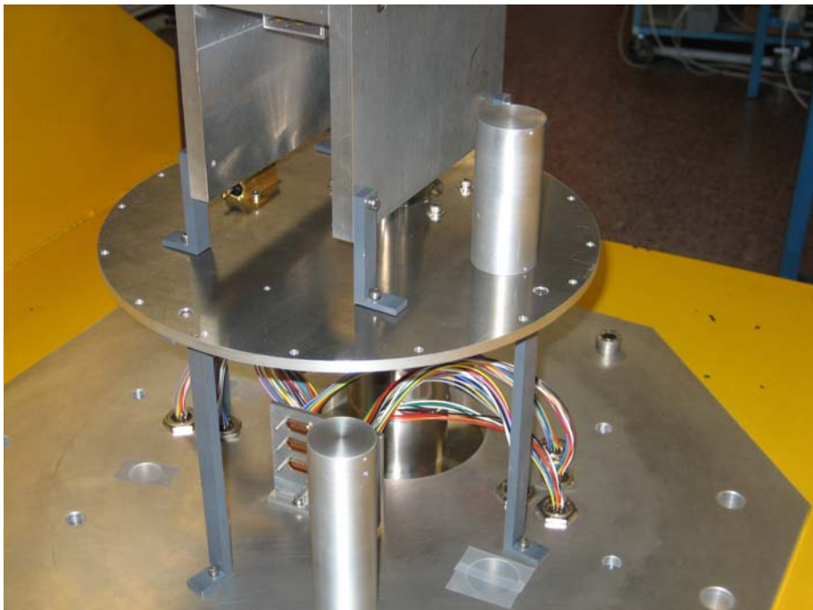
figura 20: Piezas de PVC que interconectan las etapas caliente, intermedia y fría.
