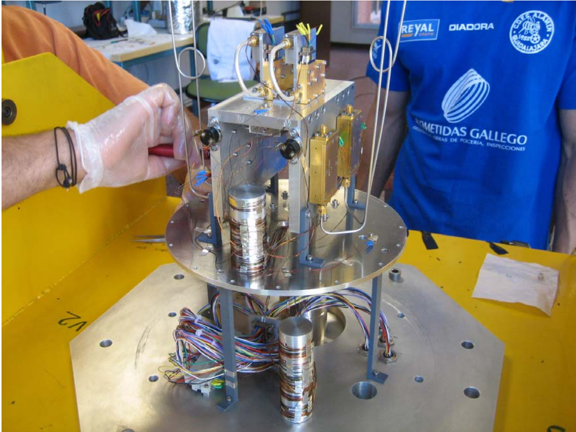
figura 82: Montaje de los cables de radiofrecuencia que interconectan la entrada al receptor con la entrada a los LNA's y la salida de los LNA's con la salida del receptor
