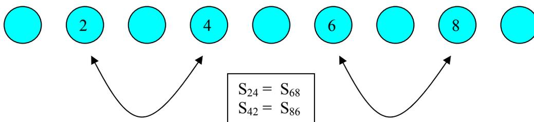
Fig. 5.1:  $S$  parameters symmetry
