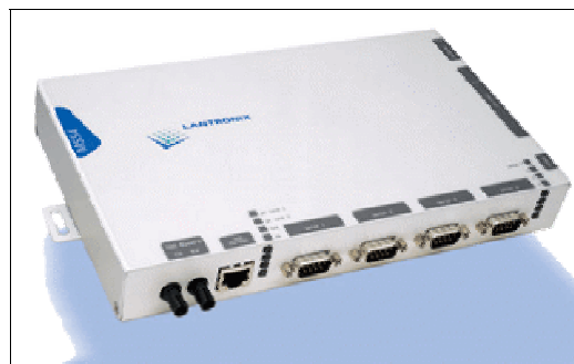
Fig. 4. Conversor serie-ethernet Lantronix
