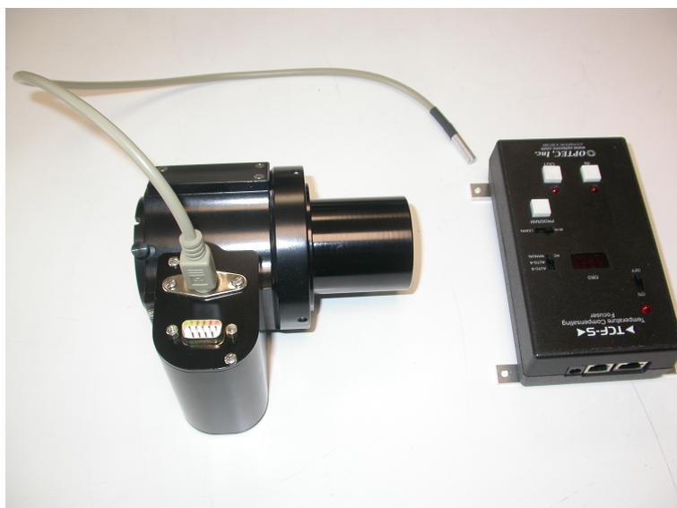
Figura 1: Sistema de enfoque: bloque central (a la izquierda), cable con la sonda de temperatura y caja de control (a la derecha)
