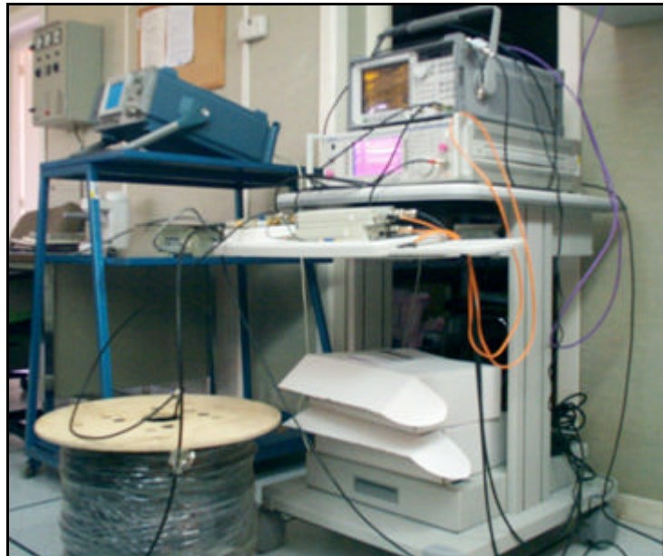
Figura 30. Aspecto del montaje de medida de la varianza de Allan del sistema transmisor de la señal del máser por cable coaxial
