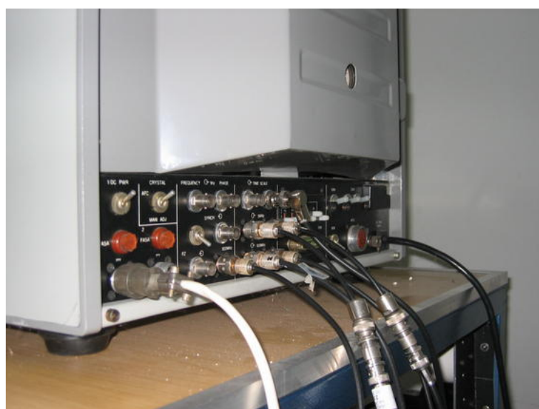
Figura 8: Vista posterior del máser. Conectores de entrada y salida.
