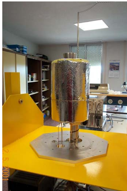
Foto 2: Vista del cilindro intermedio en el criostato. Se observan los dos componentes que lo forman. En la foto, el superaislamiento rodea ambos.
