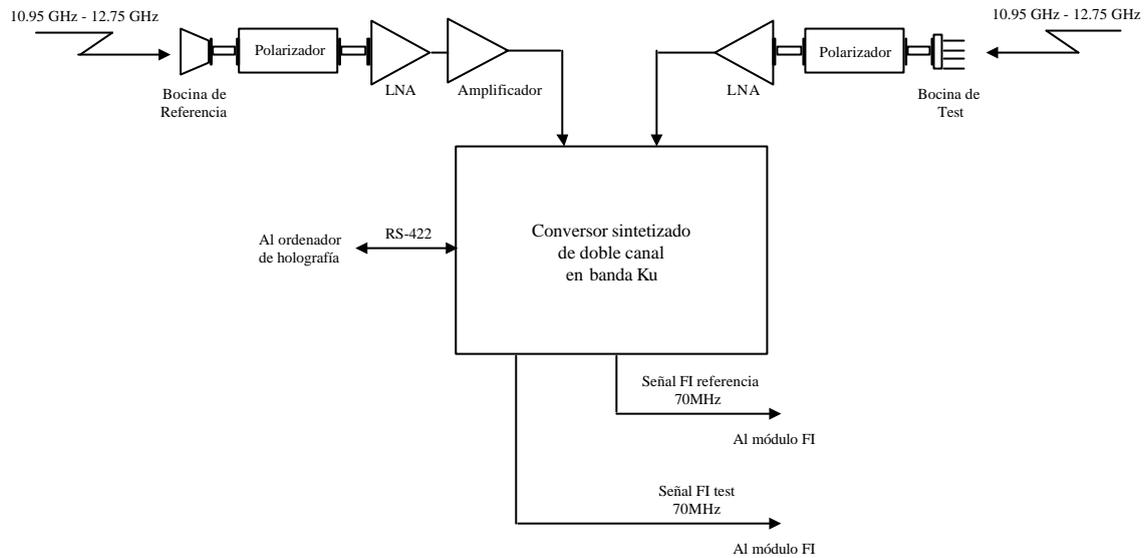
**Figura 2: Diagrama de bloques del módulo RF.**
