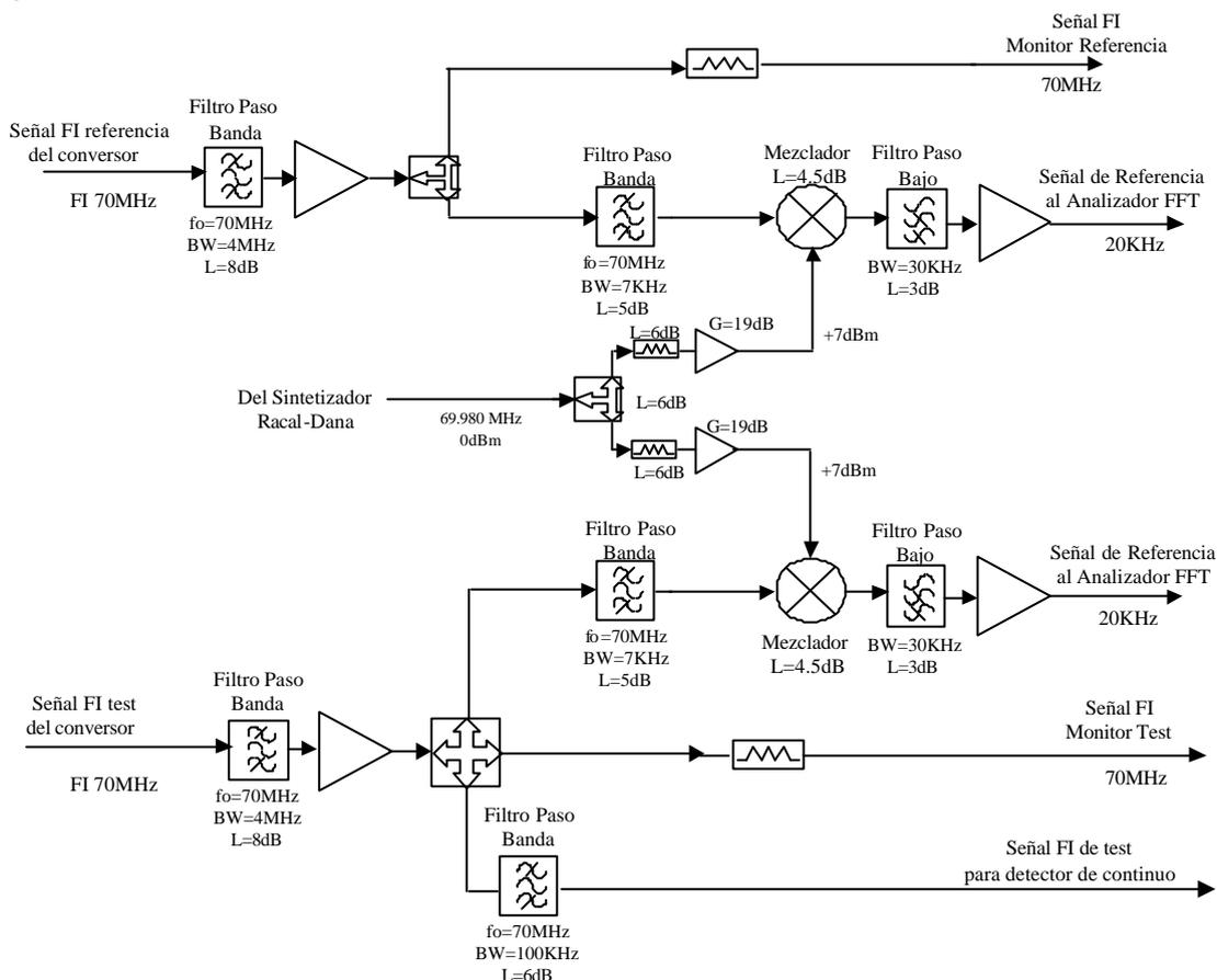
Figura 3: Diagrama de bloques del módulo FI.
