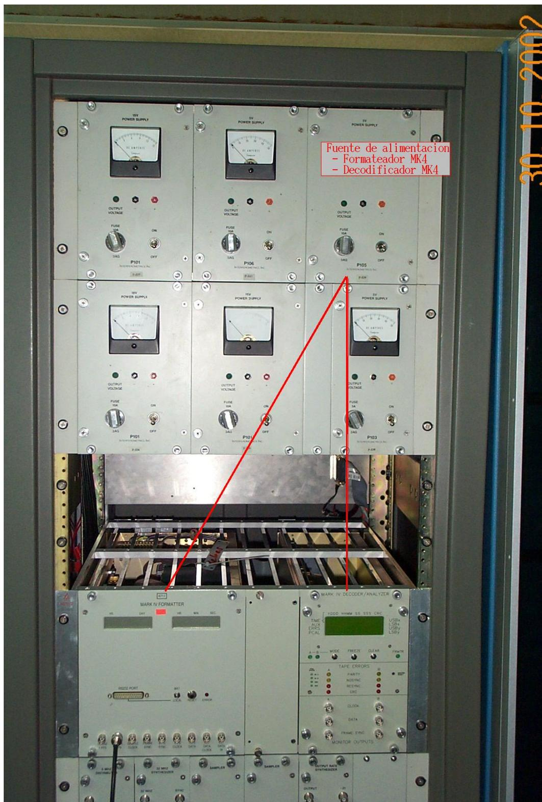
Figura 5: Vista frontal del terminal VLBA4. Se muestran las fuentes de alimentación del formateador y decodificador MK4.
