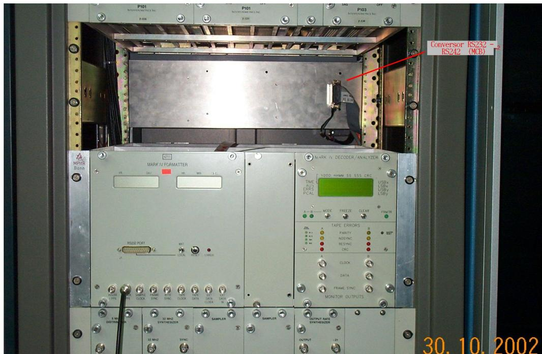
Figura 4: Vista frontal del terminal VLBA4. Huevo libre dejado por el formateador VLBA y parcialmente ocupado por el formateador y el decodificador MK4
