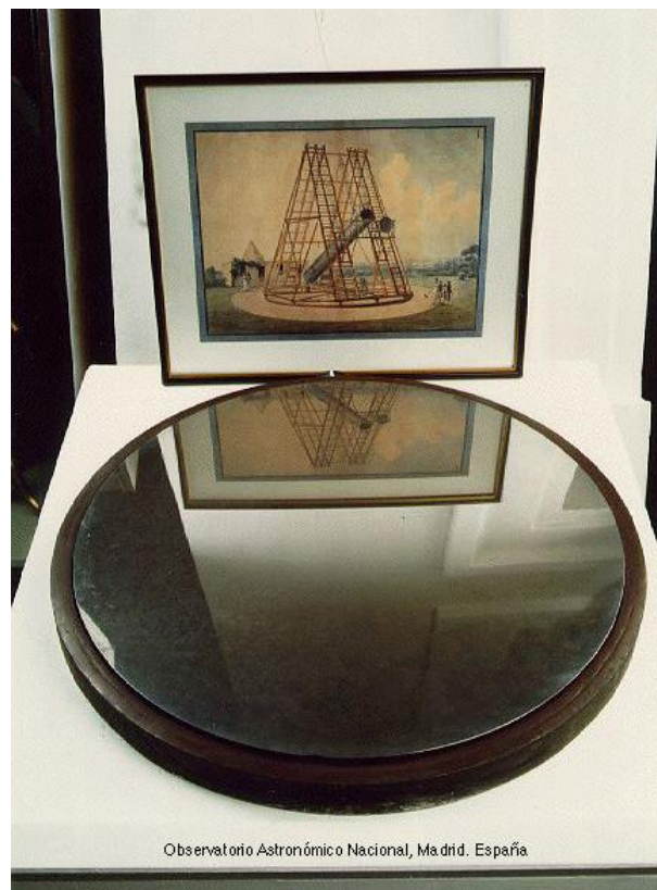
Figura 3: Espejo de 2 pies de diámetro construido y pulido por W. Herschel y expuesto en el Museo del Observatorio Astronómico de Madrid.
