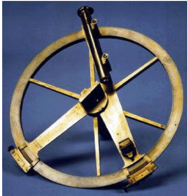
Figura 12: Círculo de reflexión de un pie de diámetro construido hacia 1790 por Troughton en Londres, expuesto en el Observatorio Astronómico de Madrid.
