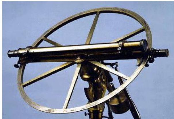
Figura 19: Círculo repetidor de aproximadamente medio metro de focal y 30 mm de apertura construido por Francisco Lorenzo en Madrid en 1804, que se encuentra en el Observatorio Astronómico de Madrid.
