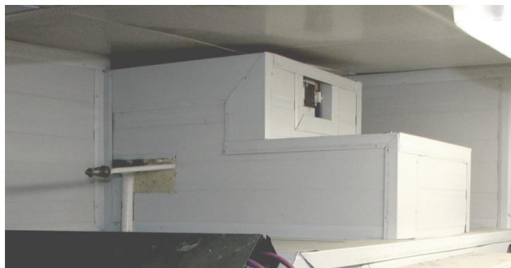
Figura 10. Detalle del aislamiento del refuerzo superior de la estructura lateral del yugo.
