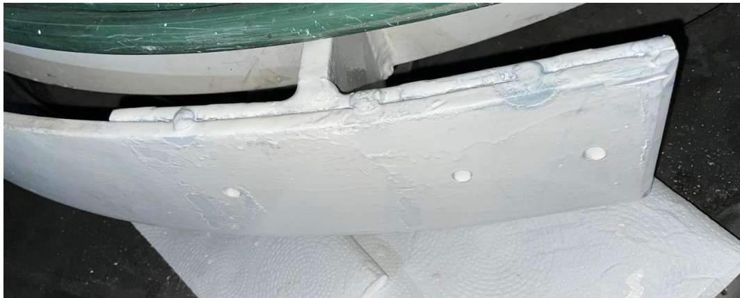
Ilustración 17. Extremo de la pletina de interfase con el recubrimiento aplicado.
