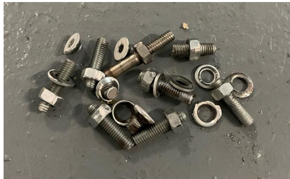
Ilustración 23. Conjunto de tornillos sustituidos con cabeza cizallada.
