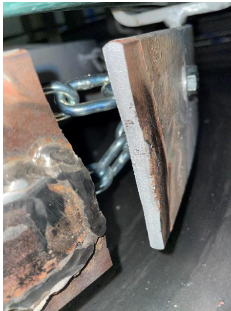
Ilustración 6. Rotura de la pletina inferior en 2023.
