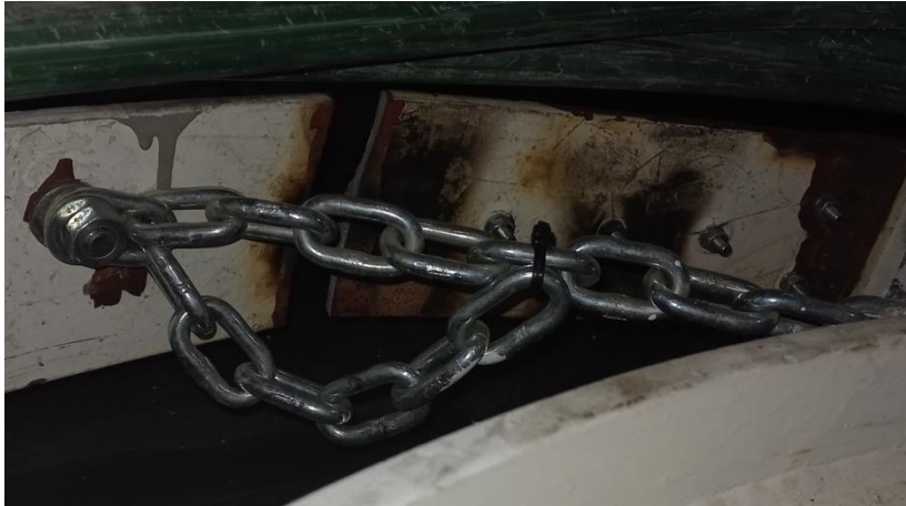
Ilustración 9. Elemento de seguridad pasivo de la pletina inferior del enrollador.
