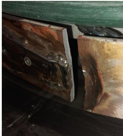
Ilustración 8. Cambio de sección en la zona de rotura.
