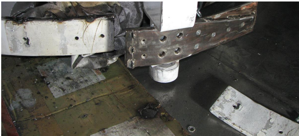
Ilustración 12. Corte de la pletina del enrollador.
