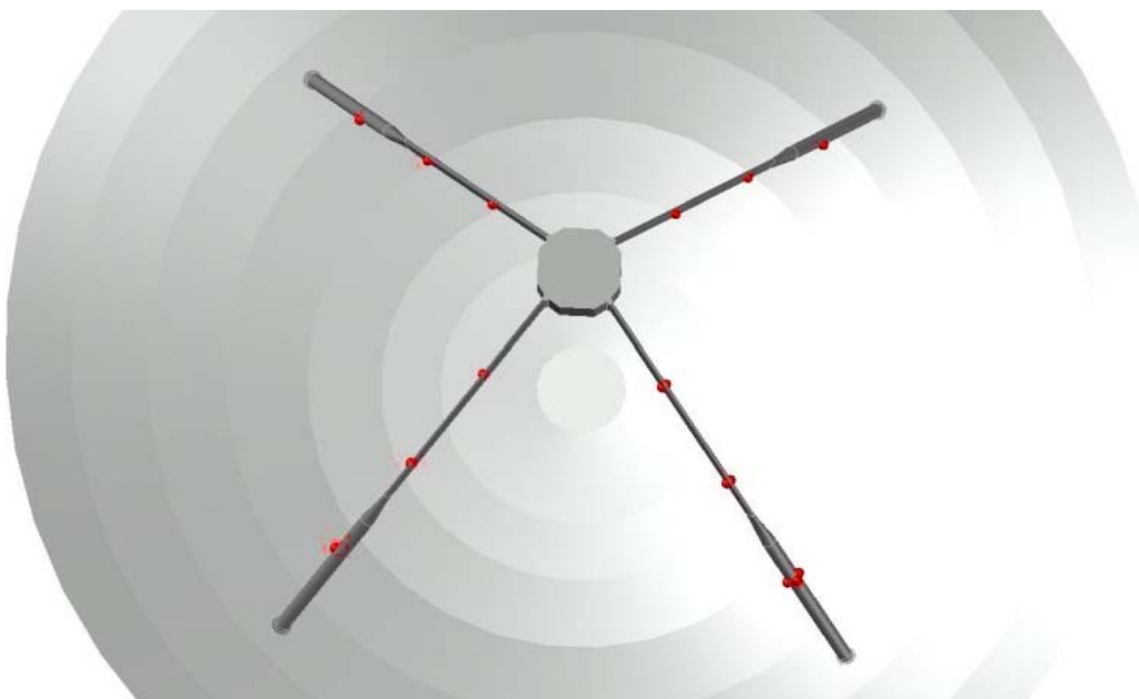
Figura 13. Distribución de los sensores instalados en las patas del tetrápodo.
