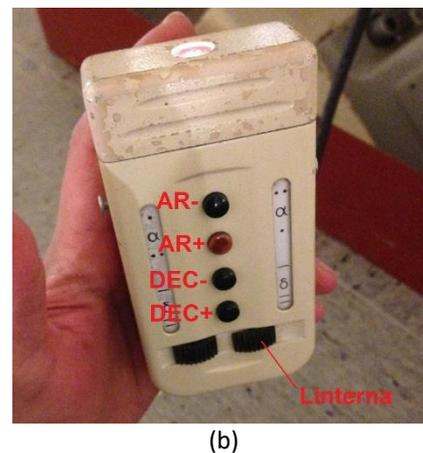
Figura A.I.5: Consola (a) y mando (b) para el control manual del astrógrafo.
