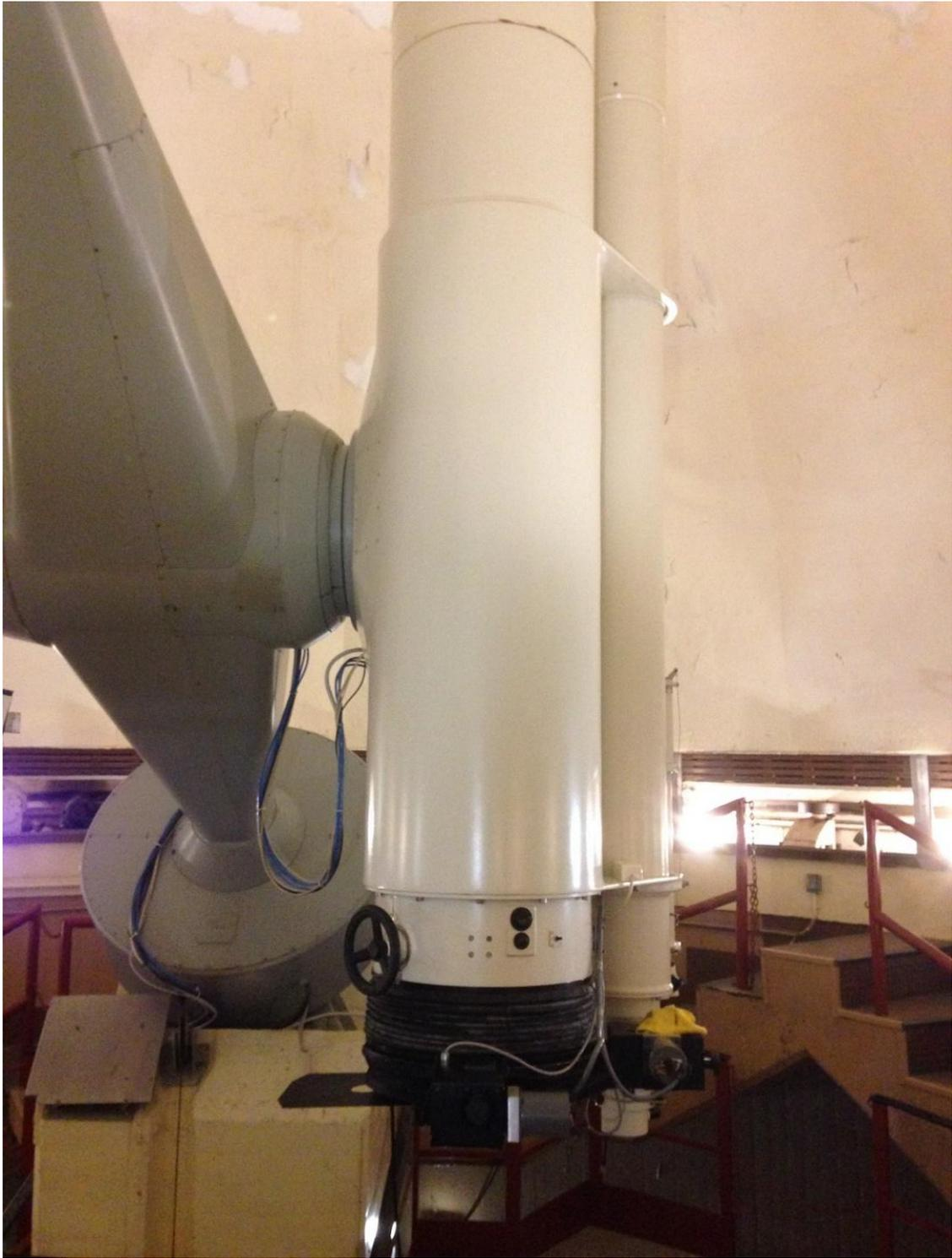
Figura 2.5.2: Astrógrafo durante las operaciones de limpieza. Se ha retirado la cámara CCD, se han tapado todos los tubos y se han cerrado todos los obturadores durante todo el proceso.
