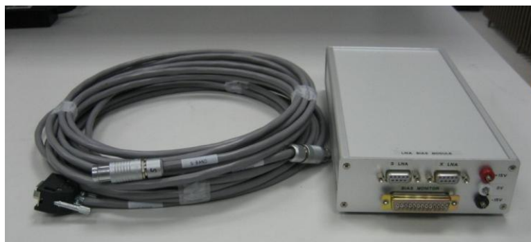
Figura 10. Módulo de polarización de los amplificadores del Receptor O'Higgins_2 y cables externos.
