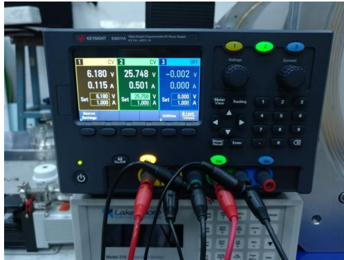
Figura 15. Conexión a la fuente de alimentación y consumo de las 4 resistencias (2 calefactoras y 2 regeneradoras).
