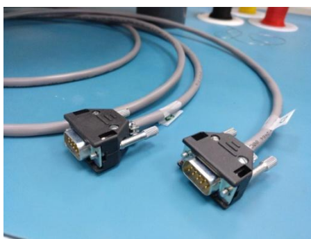
Figura 9. Conectores DB9, cableado externo de los amplificadores.
