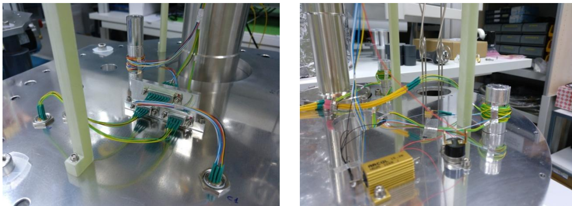
Figura 6. Pletina con los DBs y cilindros con los cables enrollados en el receptor de Banda Ancha de Finlandia, año 2018 ⇒ Ya se ha utilizado todo el cableado de colores .
