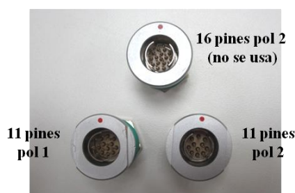
Figura 1. Polarización de los conectores Fischer.
