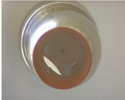
Figura 4.2. Reflector RRR adosado magnéticamente a la cara interna de uno de los contrapesos.
