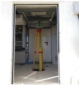
Figura 4.1. Estación TS30 montada en el trípode sobre el pilar situado en el interior de la cabina del radiotelescopio
