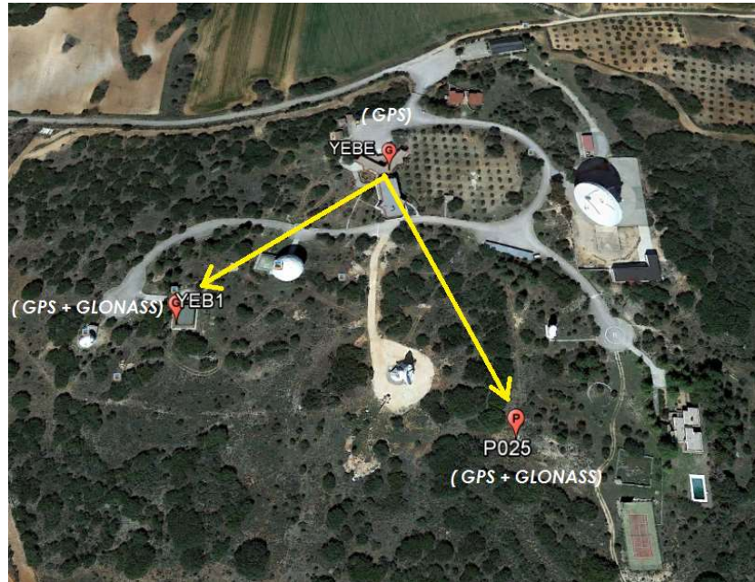
Ilustración 5 – Localización de los puntos procesados dentro del Observatorio de Yebes e imposición de las líneas base entre ellos
