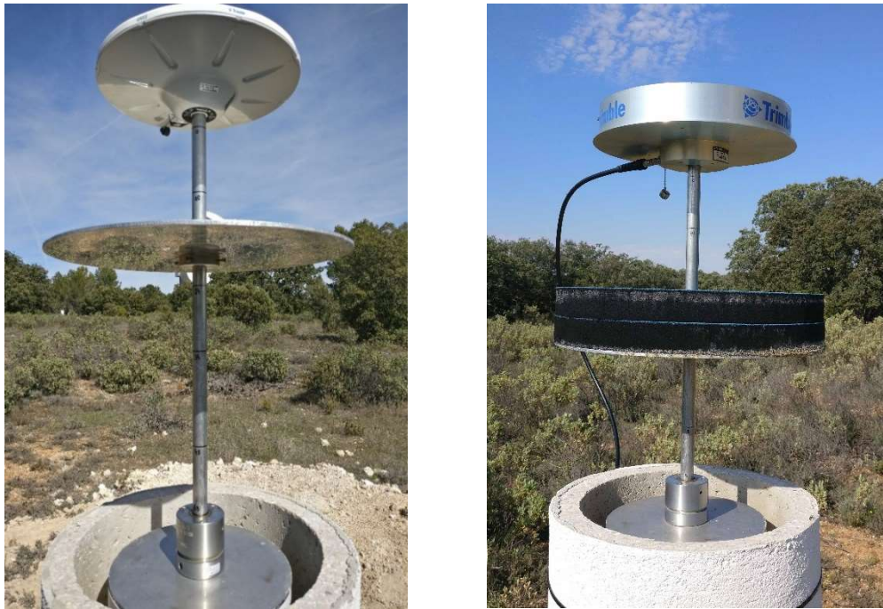
Ilustración 4 - Observación con disco metálico (izquierda) y discos absorbentes L1 sobre el propio disco metálico (derecha)
