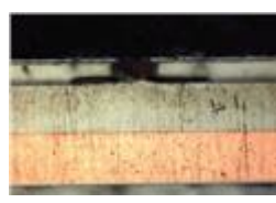
D. Sección transversal de un depósito de níquel con alto contenido en azufre corroído.
