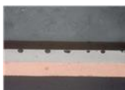
C. Sección transversal de la corrosión encontrada bajo un recubrimiento de níquel microporoso.
