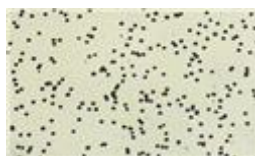
A. Patrón de porosidad típico para un recubrimiento Ni-Cr
