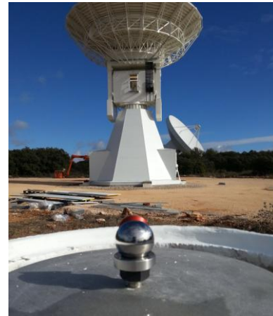
Figuras 3.3 y 3.4 Leica Red Ring Reflector (RRR) en pilar utilizado como referencia.
