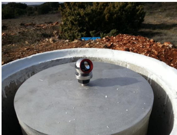
Figuras 3.3 y 3.4 Leica Red Ring Reflector (RRR) en pilar utilizado como referencia.
