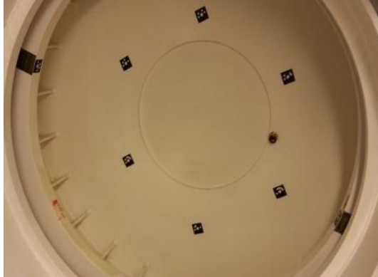
Figura 3.1. Reflector RRR adosado magnéticamente a la cara interna de uno de los contrapesos.
