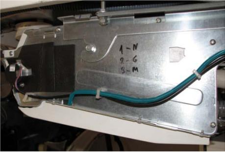
En el lateral hay dos cables, uno conectado al motor de la compuerta de salida del aire (en el lateral) y otro al módulo inalámbrico, en la figura resaltado en cyan (el que se mete hacia abajo). Cortar éste último.
