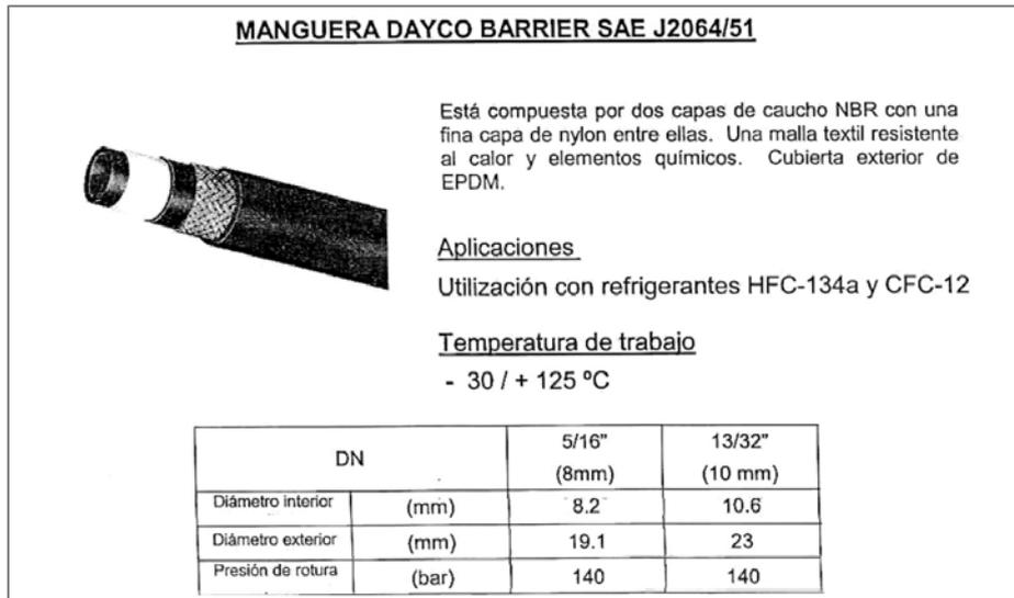
**Figura 21.** Manguera flexible para climatización..
