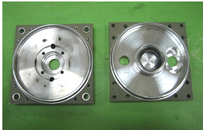
Bridas superior e inferior del motor. En la brida inferior en el canal del rodamiento hay situadas dos arandelas elásticas (colocadas de forma “contrapeada”).
