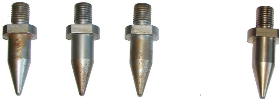
Figura 20. Pines delanteros. A la izquierda tres ejemplos de los pines originales, donde se observan zonas oxidadas. A la derecha un pin nuevo.
