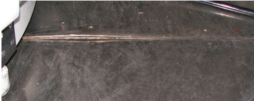
Figura 16. Estado de la chapa-D tras ser doblada.
