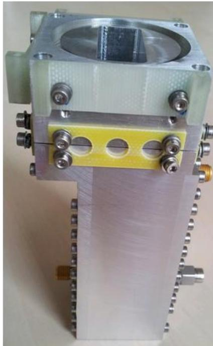
Figura 24: Foto de las cuatro piezas unidas por los soportes de fibra.
