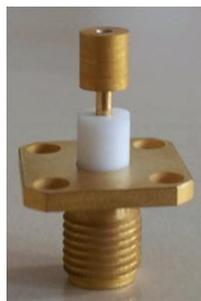
Figura 16: Foto del conector con disco construido.
