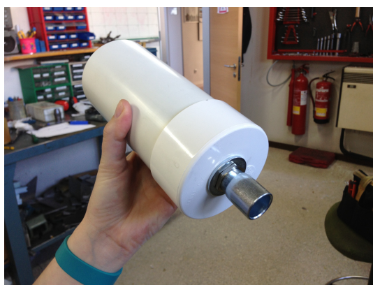
Fig. 3 - Anclaje para sujetar la carcasa del SQM al mástil
