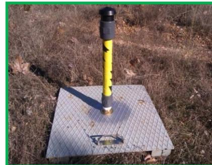
Figura 3.4. Tubería piezométrica realizada en el Observatorio
