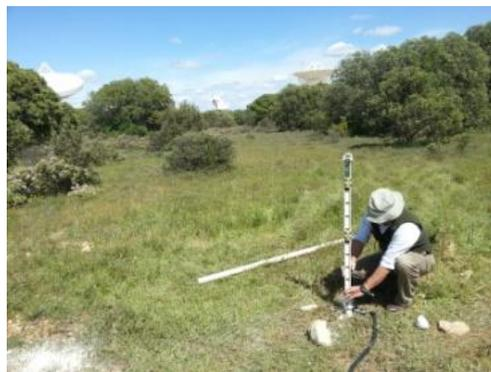
**Figura 3.6. Instalación del sensor de humedad en el Observatorio**
