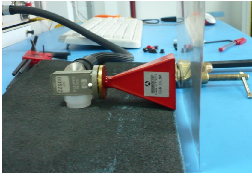
Figura 2 : La configuración de la medida en banda Q con el corto después de la apertura de la bocina
